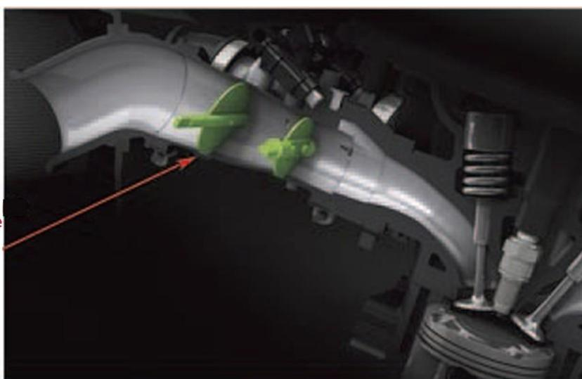
Sistema di iniezione: corpo farfallato 32,00 mm Ø per 2 (Keihin) con doppia valvola ovale. La valvola secondaria viene asportata completamente.
